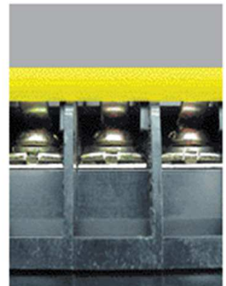
端子台に短絡板を装着時 ・ネジ頭部に短絡片が 接触している状態
