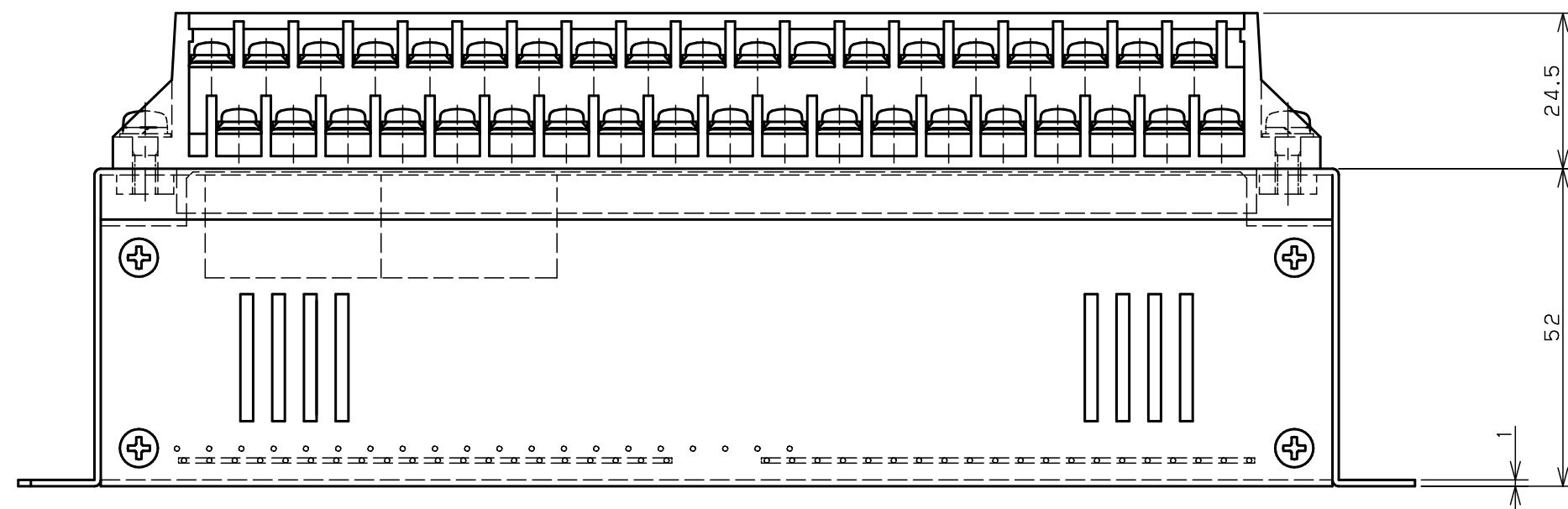
PLC変換アダプタ/三菱電機対応
