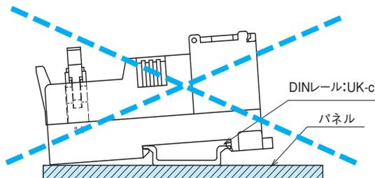
DINレール:UK-c をパネルに取り付けた状態での PSWR(PXWR)の脱着はできません。
