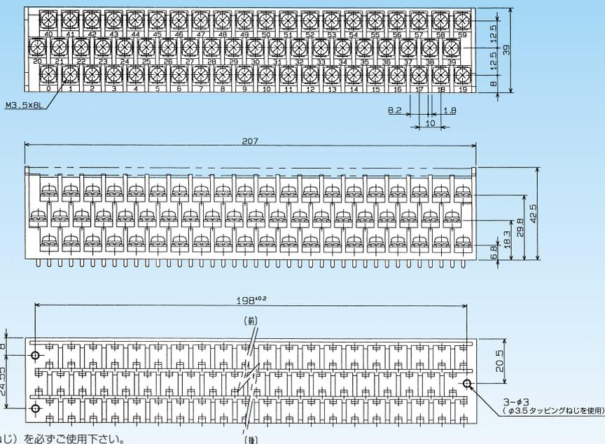
注：プリント基板に実装の際は裏面取り付けねじ（φ3.5タッピングねじ）を必ずご使用下さい。
